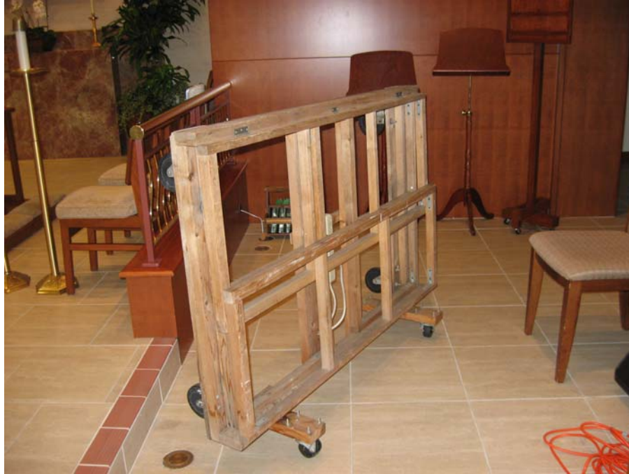
Chân toà Đức Mẹ gấp xếp lại rất gọn gàng, đỡ choáng chỗ trong nhà kho. Chân toà dựng đứng (hình trên), để nằm (hình dưới). Cả 2 chiều đều có bánh xe để đùn lăn đi, khỏi phải khiêng.
