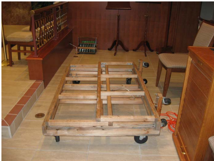
Chân toà Đức Mẹ gấp xếp lại rất gọn gàng, đỡ choáng chỗ trong nhà kho. Chân toà dựng đứng (hình trên), để nằm (hình dưới). Cả 2 chiều đều có bánh xe để đùn lăn đi, khỏi phải khiêng.
